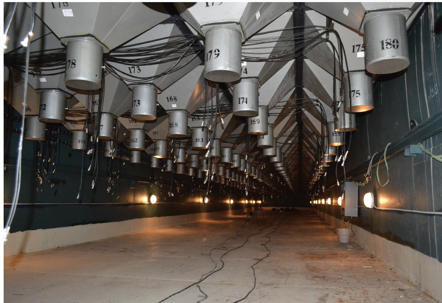
Мюонный детектор установки «Ковер-2»
